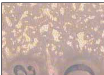
Powiększony widok pęcherzyków powietrza pod przyklejoną płytą fotopolimerową
